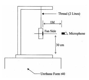
1 METER FROM MICROPHONE TO FAN INTAKE
