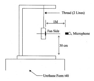
1 METER FROM MICROPHONE TO FAN INTAKE
