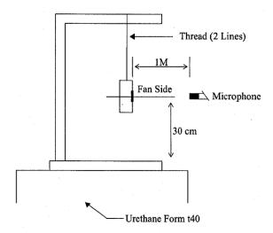
1 METER FROM MICROPHONE TO FAN INTAKE
