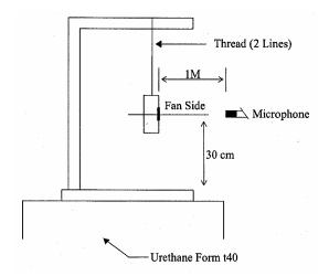
1 METER FROM MICROPHONE TO FAN INTAKE
