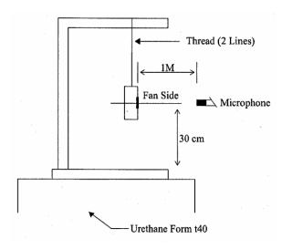
1 METER FROM MICROPHONE TO FAN INTAKE
