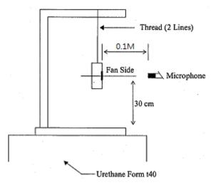
0.1 METER FROM MICROPHONE TO FAN INTAKE
