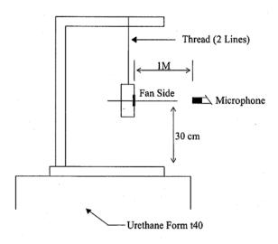
1 METER FROM MICROPHONE TO FAN INTAKE
