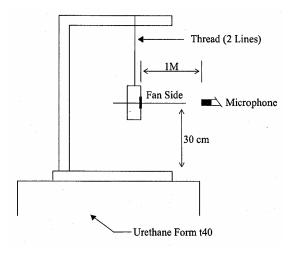
1 METER FROM MICROPHONE TO FAN INTAKE
