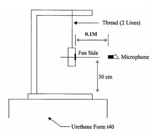
0.1 METER FROM MICROPHONE TO FAN INTAKE
