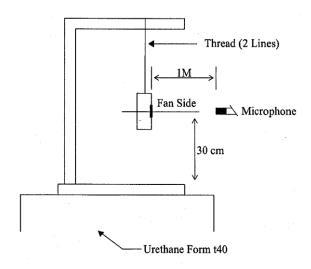
1 METER FROM MICROPHONE TO FAN INTAKE
