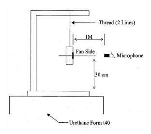
1 METER FROM MICROPHONE TO FAN INTAKE
