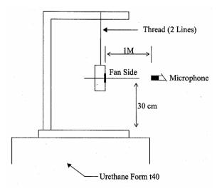
1 METER FROM MICROPHONE TO FAN INTAKE
