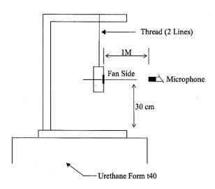
1 METER FROM MICROPHONE TO FAN INTAKE
