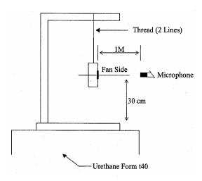
1 METER FROM MICROPHONE TO FAN INTAKE
