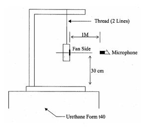
1 METER FROM MICROPHONE TO FAN INTAKE
