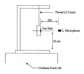
1 METER FROM MICROPHONE TO FAN INTAKE
