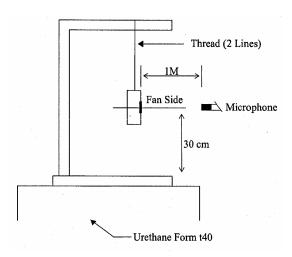
1 METER FROM MICROPHONE TO FAN INTAKE
