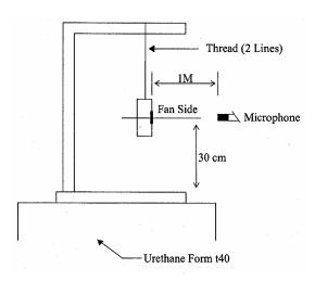
1 METER FROM MICROPHONE TO FAN INTAKE
