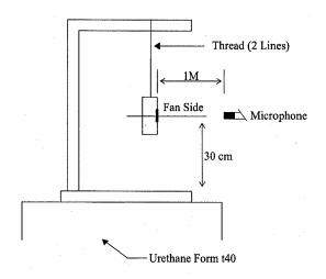
1 METER FROM MICROPHONE TO FAN INTAKE
